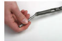
Einsatz ist zu groß. Er lässt sich nicht ansetzen.
